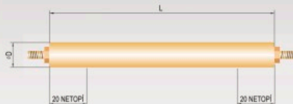
Topné patrony s oboustrannými vývody a mosazným pláštěm
