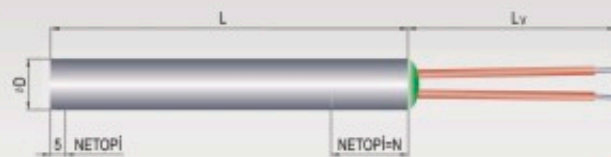
Dokonale utěsněné patrony pomocí olovnatého skla
